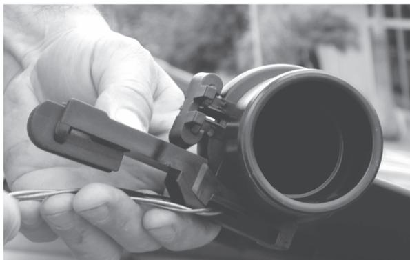
Figura 12: Detalhe da amarração do Suporte SLED usando fio de cobre
