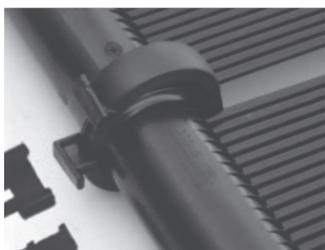
6 - Passe o gancho da abraçadeira de encaixe inferior por dentro da fenda da abraçadeira de encaixe superior, gire a parte superior e trave as duas peças com a presilha do kit, deslizando a parte mais larga da presilha sobre a parte mais fina da cunha de travamento das abraçadeiras.
